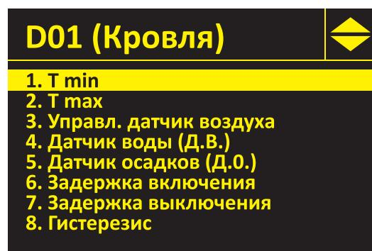
Рис. 3.2.3. Меню конфигурации канала D01 (Кровля)
