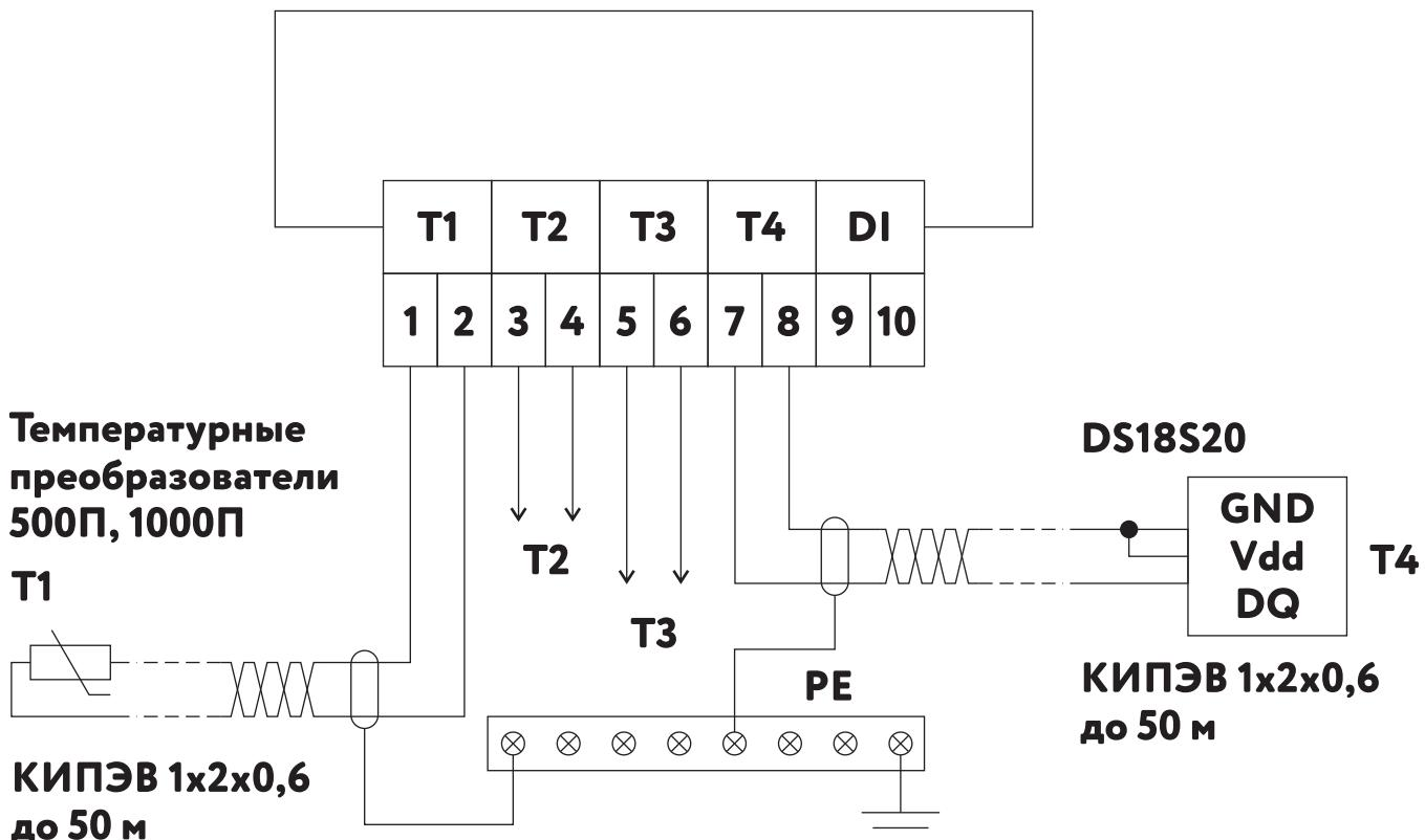
Рис. 4.4.1. Принципиальная схема подключения для Т1-Т4
