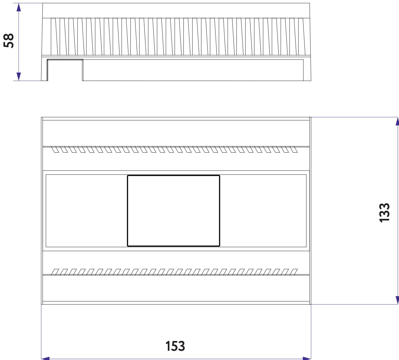
Рис. 4.2. Габаритные размеры контроллера
