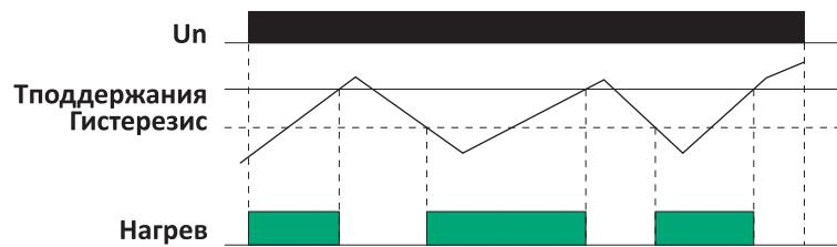
Рис. 3.2.6. Принцип работы гистерезиса канала DO2
