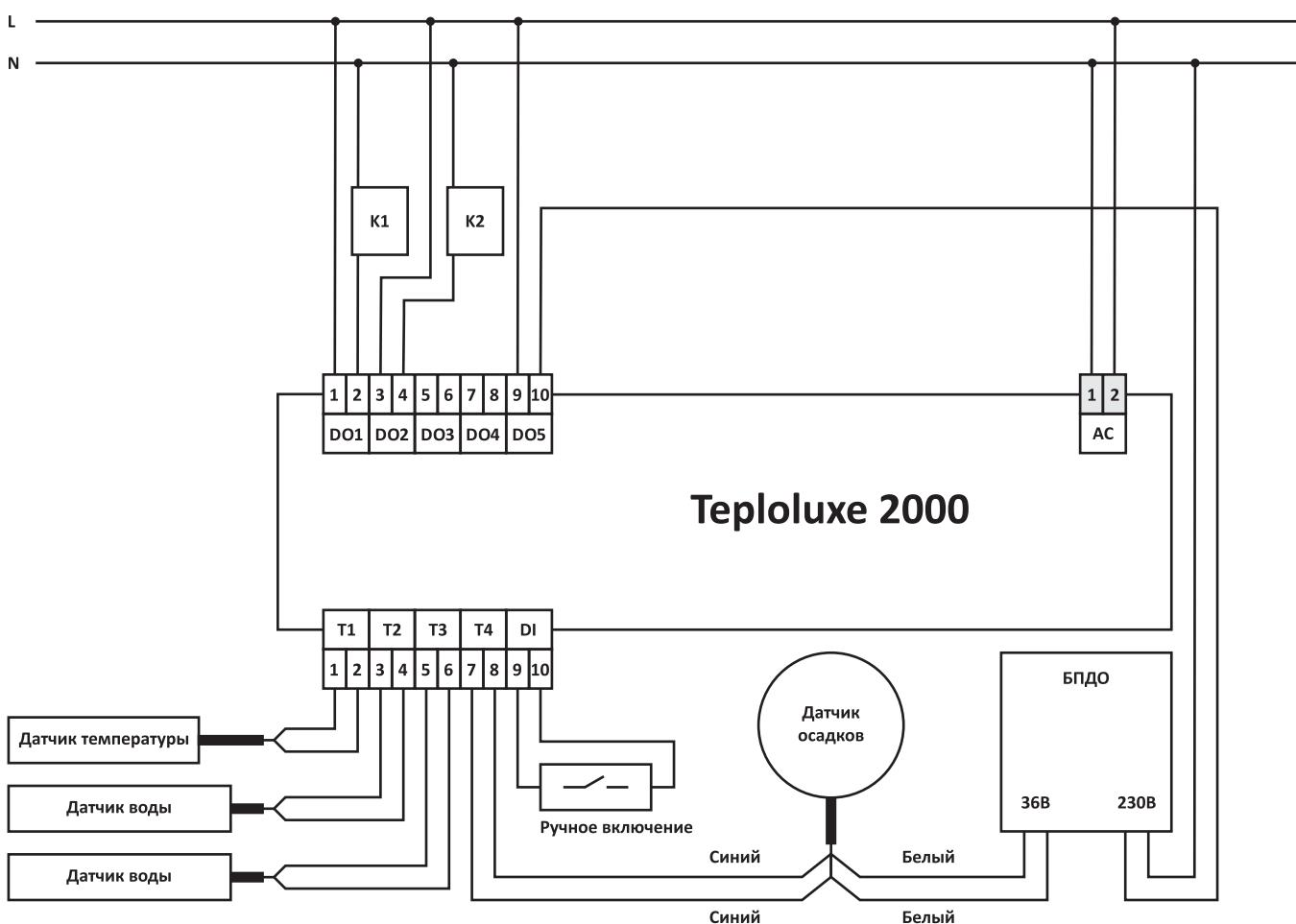
Рис. 3.2.1. Принципиальная схема подключения в режиме «Кровля/Двор»
