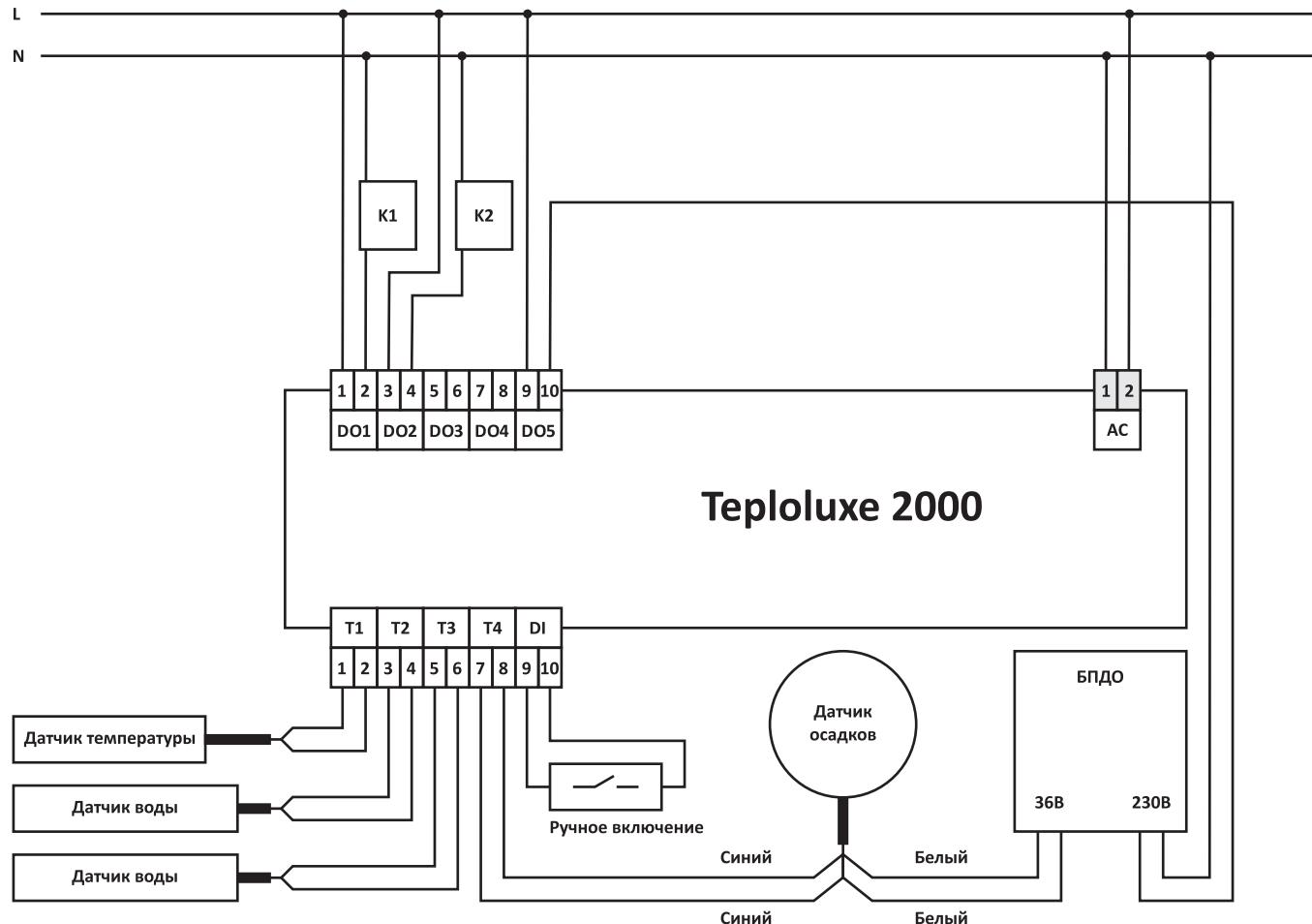
Рис. 3.1.1. Принципиальная схема подключения в режиме «Кровля»
