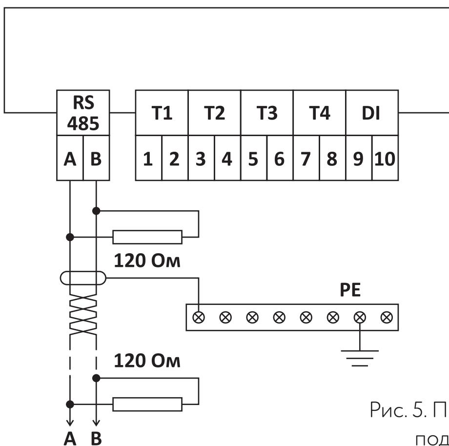
Рис. 5. Принципиальная схема подключения для RS-485
